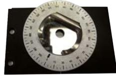
Platine tournante 90x65 mm porte lame mince à poser sur la platine du microscope = polariseur
