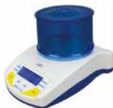
Compacte et durable, aucune autre balance n'offre autant de valeur que la Core pour le pesage de base. Son châssis en plastique ABS durable est facilement nettoyable et la protection des déversements, ce qui rend la Core idéale pour une utilisation en classe. Elle est dotée d'un clavier simple à utiliser avec deux touches tare. La protection ShockProtect® empêche les dommages dus à des surcharges.
